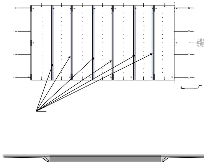
Dérouler la couverture en positionnant les profils du kit neige à côté des profils aluminium de la couverture pour permettre une bonne évacuation des eaux pluviales.
