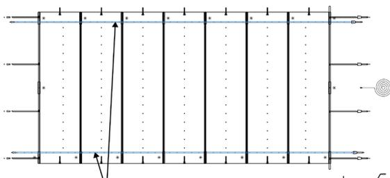
Sangles positionnées sur le **dessus** de la couverture
