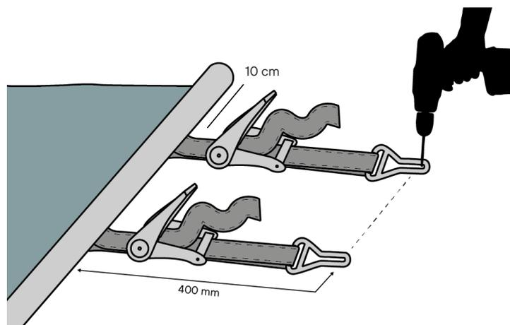
Les pitons et pitons à douilles doivent être fixés sur un dallage solide (dalle béton) et dans le strict respect des conseils de pose.
