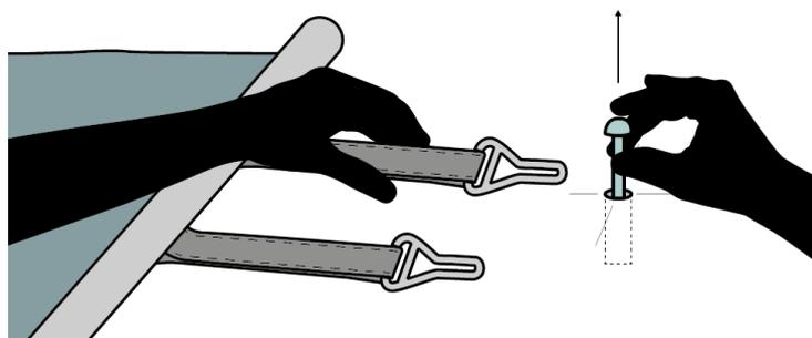
**IMPORTANT** : se positionner à l'autre bout de la piscine, face à la zone déjà fixée. Les cliquets de tension doivent être positionnés à 10 cm de chaque extrémité du tube d'enroulement. Puis répartir les autres cliquets à distance égale. Bloquer les sangles en translation, en serrant les vis de blocage positionnées dans la gorge du profil à l'aide de la clé Allen fournie. Si la couverture dispose d'une bavette escalier, positionner également les cliquets de tension à l'endroit des sangles.
